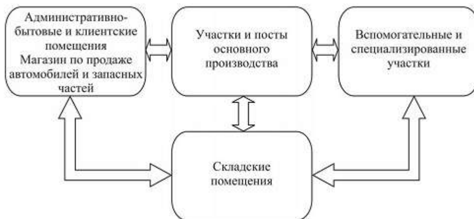
Рисунок 1 – Функциональное зонирование станций технического обслуживания
