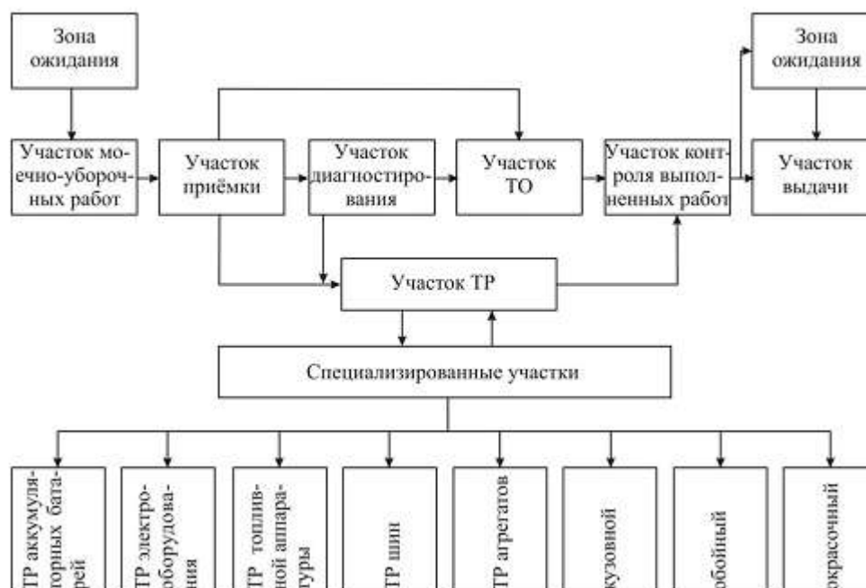
Рисунок 2 – Схема технологии производства СТОА
