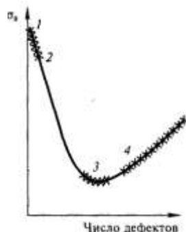
Рис. 6. Зависимость прочности металла от плотности дислокаций
