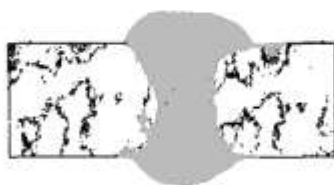
Рис. 5 Химическая неоднородность сварного соединения
