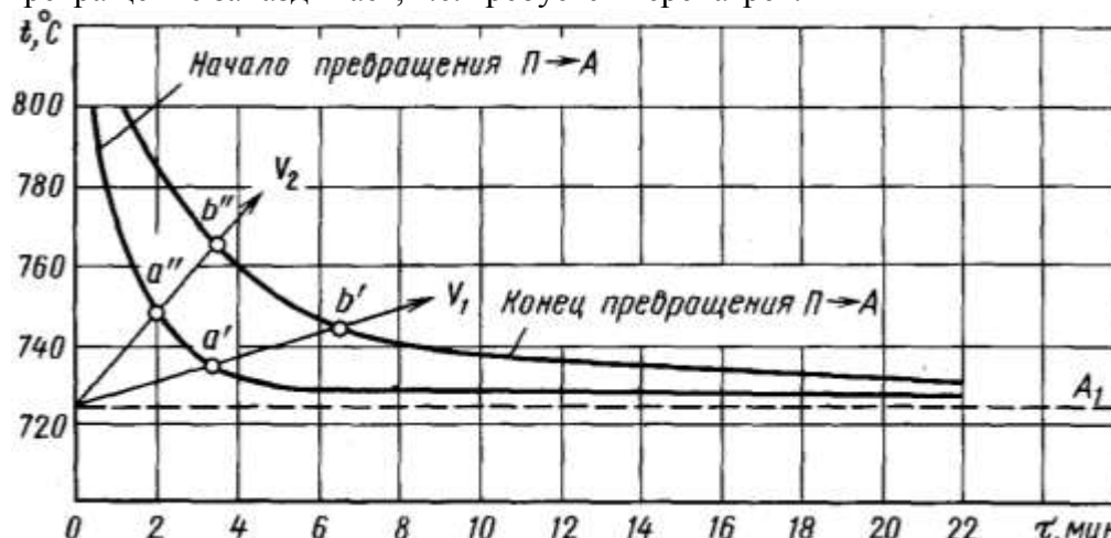
Рис. 2. Превращения перлита (П) в аустенит (А) при постоянной температуре
