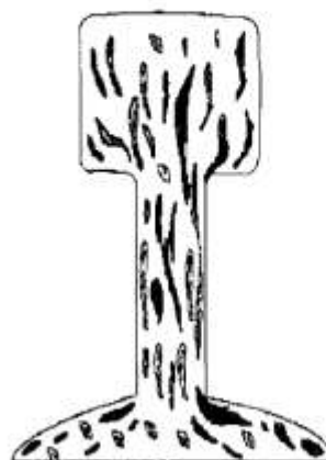
Рис. 6 Ликвация серы в стали
