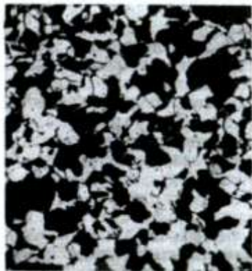
Рис. 4. Сталь доэвтектоидная (перлит и феррит)
