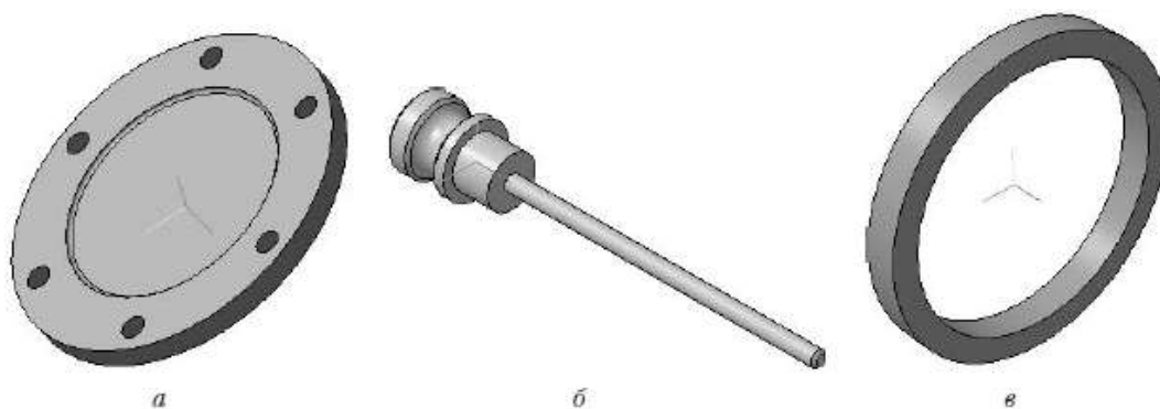
Рис. 3.107. Детали редуктора: глухая крышка подшипника (а), маслоуказательный жезл (б), кольцо распорное (в)
