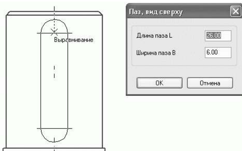
Рис. 2.99. Построение изображения шпонки (шпоночного паза) средствами КОМПАС
