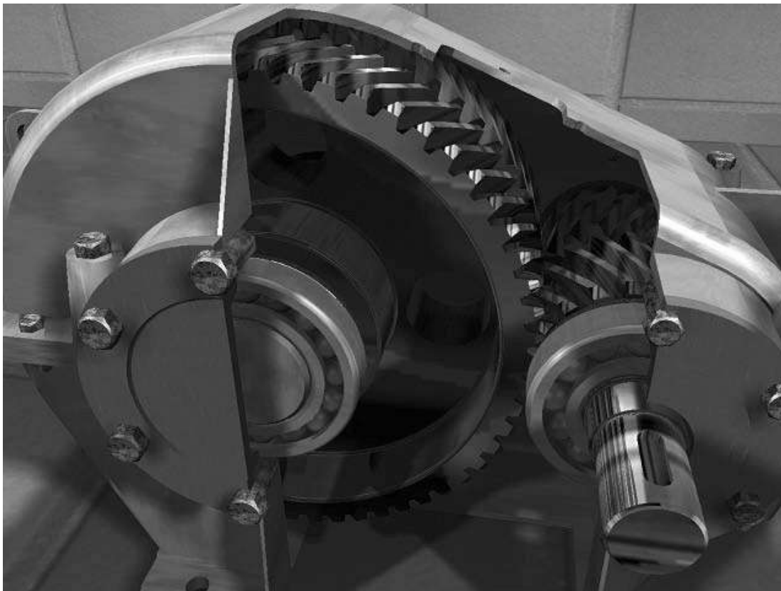
Рис. 2.79. Одноступенчатый цилиндрический шевронный редуктор (корпус в разрезе)
