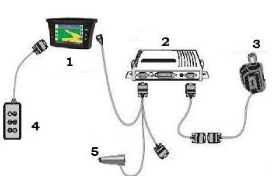
Рис.1.14 Система автоматического управления AgGPS EZ-Steer
