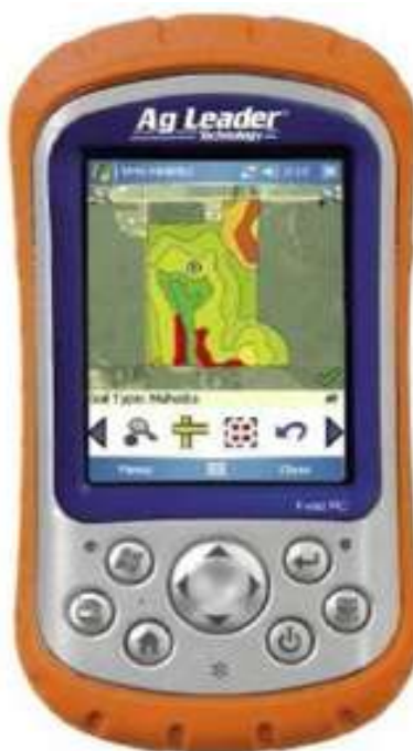
Рис.2.1 Полевой компьютер SMS Mobile
