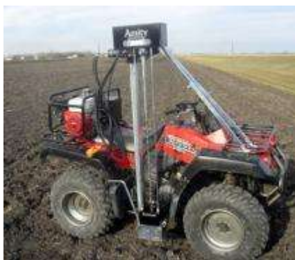
Рис. 4.2 Автоматический пробоотборник Amity-Concord 2036 ATV Mount.
