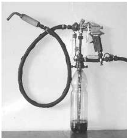
Рис. 6. Консервационное устройство ПРК-5-28
