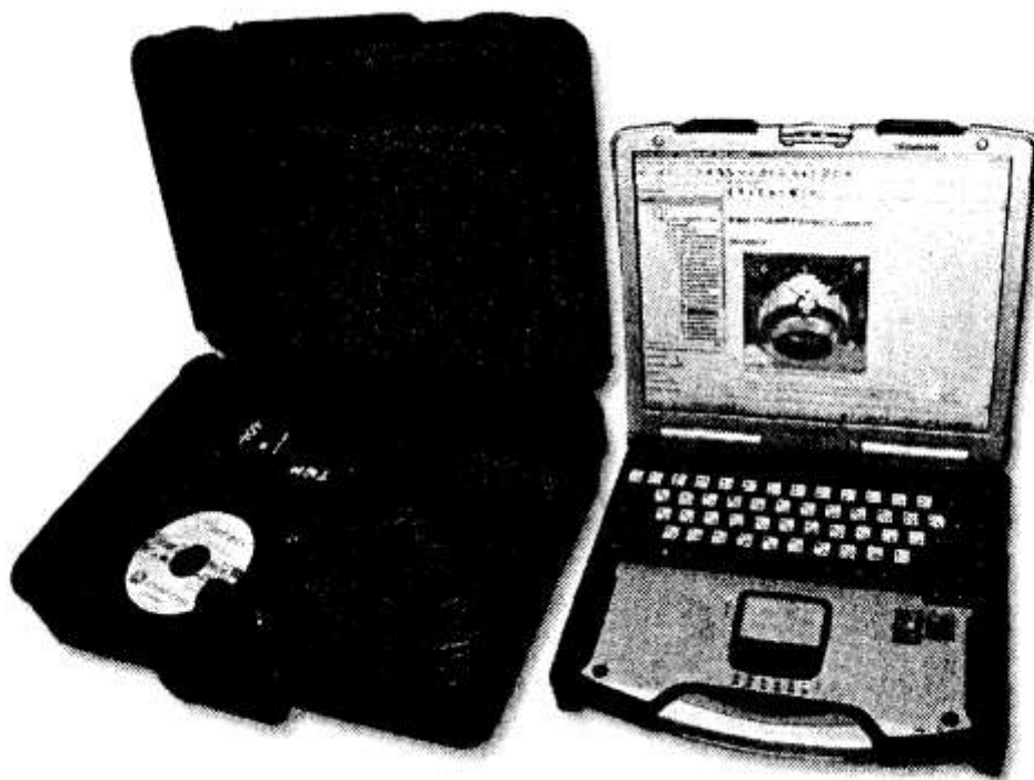
Рисунок 4.3 - Специализированный системный тестер Adviseer для диагностирования мобильной техники фирмы John Deere
