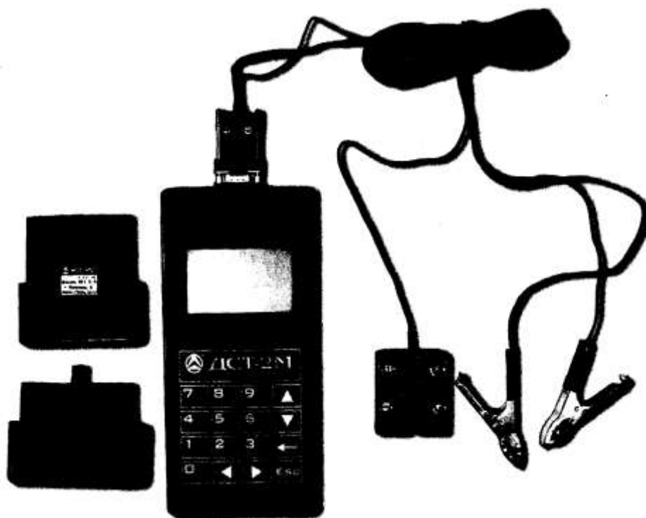
Рисунок 4.1 - Сканер ДСТ-2М со сменными картриджами и адаптером
