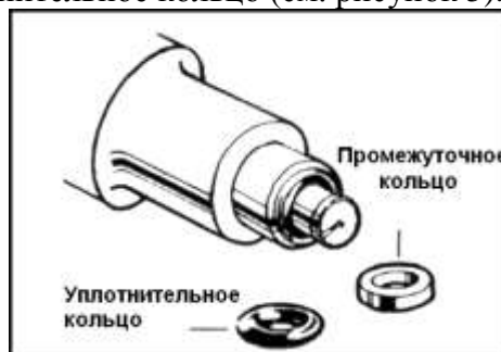
Рисунок 5 - Снятие нижнего уплотнительного кольца
