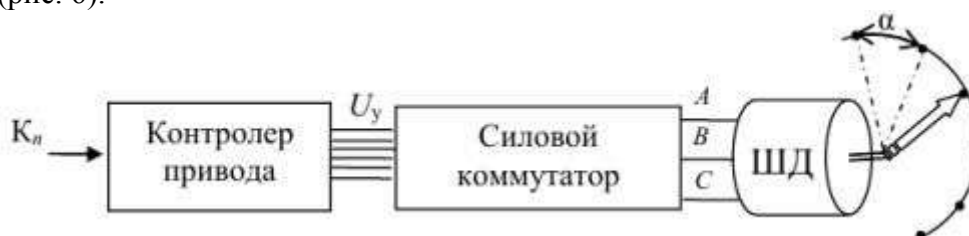
Рис. 6. Устройство управления шаговым электродвигателем
