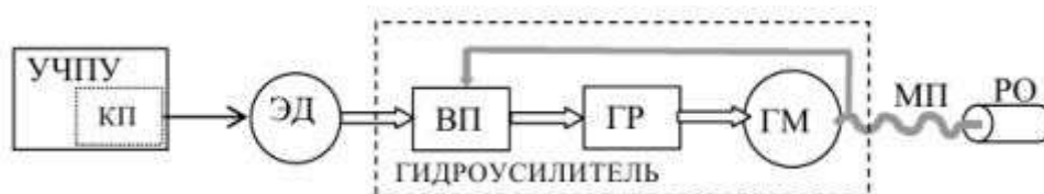
Рис. 5. Функциональная схема электрогидропривода
