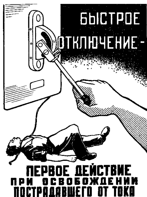
Рис 1. Освобождение пострадавшего от действия тока - отключение электроустановки (плакат)
