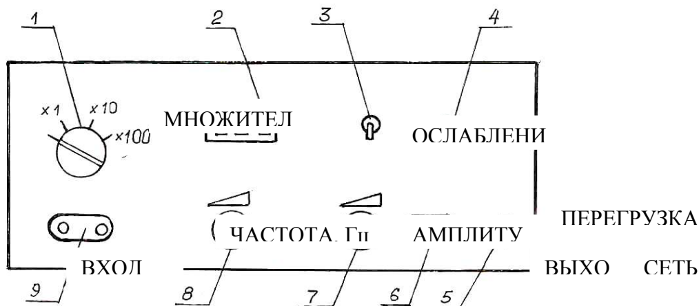
Рис. 6. Лицевая панель генератора низкочастотных сигналов
