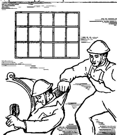
Рис. 3. Освобождение пострадавшего от действия тока в установках до 1000 В - оттаскивание за сухую одежду
