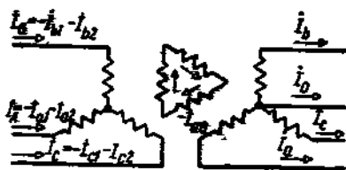
Рис. 2-68. Несимметричная нагрузка трехобмоточного трансформатора при соединении обмоток Y/\Delta/Y_0 .
