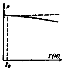
Рис. 5-58. Скоростная n = f(I) или механическая n = f(M) характеристика двигателя с параллельным возбуждением.
