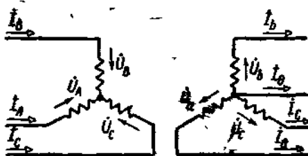
Рис. 2-59. Несимметричная нагрузка трансформатора при соединении его обмоток Y/Y_0 .
