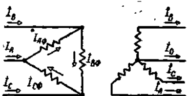
Рис. 2-66. Несимметричная нагрузка трансформатора при соединении его обмоток \Delta/Y_0 .
