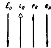
Рис. 5-37. К определению полярности дополнительных полюсов двигателя.
