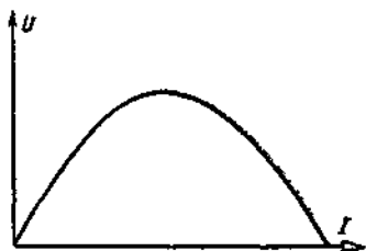
Рис. 5-53. Внешняя характеристика генератора с последовательным возбуждением.
