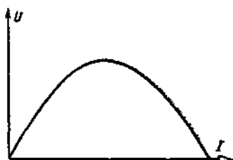
Рис. 5-53. Внешняя характеристика генератора с последовательным возбуждением.
