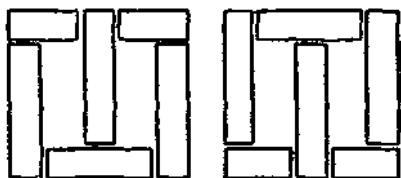
Рис. 2-3. Листы сердечника трехфазного трансформатора при сборке их «внахлестку».
