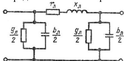
П-образная схема замещения воздушной линии электропередачи.
