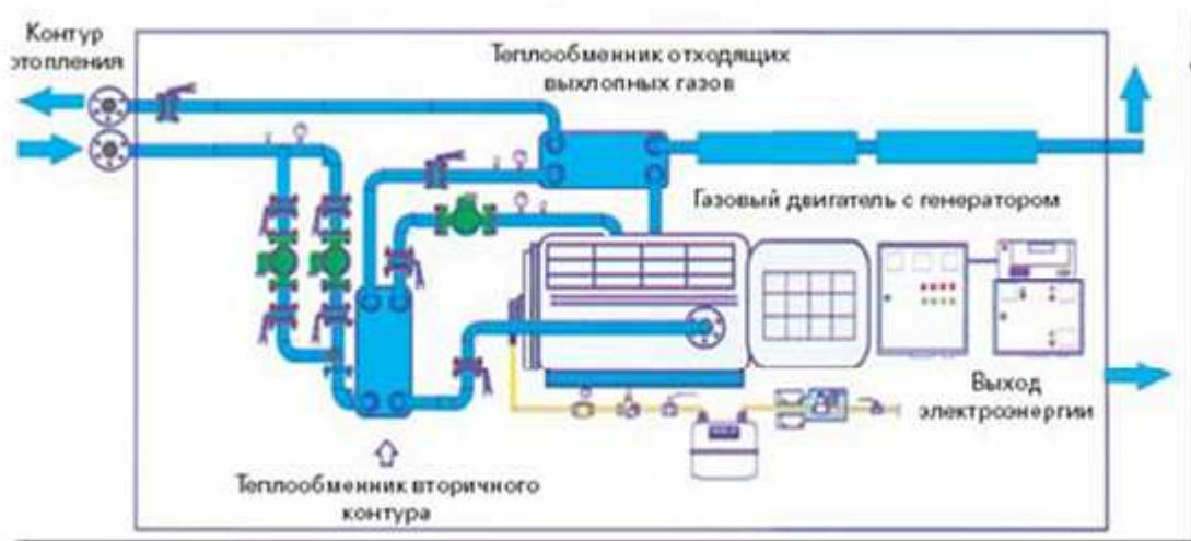
Рис.7. Принципиальная схема газопоршневой когенерационной установки
