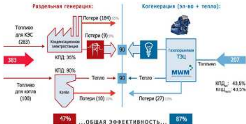
Рис.1. Сравнение энергетических потоков при раздельной и комбинированной выработке энергии (когенерация), (данные приведены в условных единицах топлива).
