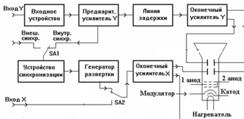
Рис.1 – Структурная схема осциллографа (базовая модель)
