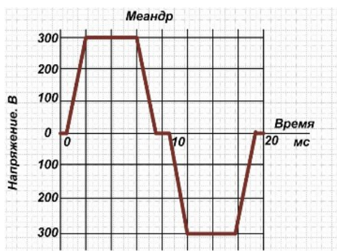
Рис.6 – Форма выходного напряжения автономного инвертора (трапеция)
