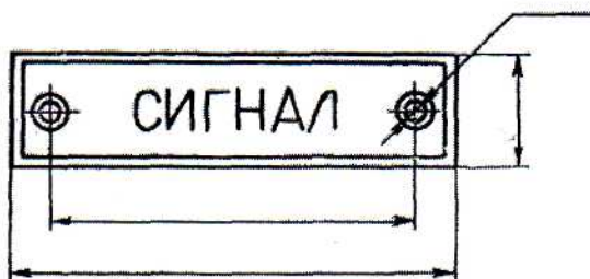
Рис.6. Простановка размеров для нанесения надписи на изделия
