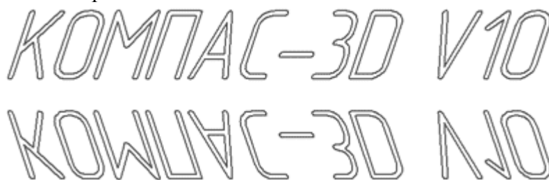
Рис. 2.40. Зеркально отобразить текст можно после его преобразования в NURBS-кривые
