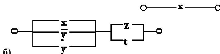
**Решение:**  $F(x; y; z; t) = (x \vee \bar{y} \vee y) \cdot (z \vee t) = 1 \cdot (z \vee t) = z \vee t$ .
