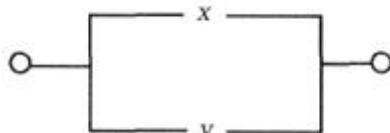
Схема проводит ток, когда хотя бы один из переключателей замкнут, следовательно,  $F(x) = x \vee y$ .
