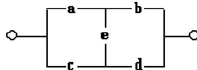
**Решение.** Имеется четыре возможных пути прохождения тока при замкнутых переключателях  $a, b, c, d, e$ : через переключатели  $a, b$ ; через переключатели  $a, e, d$ ; через переключатели  $c, d$  и через переключатели  $c, e, b$ . Функция проводимости
