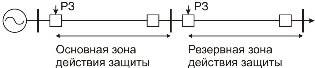
Резервирование следующего участка – важное требование. Если защита по принципу своего действия не работает за пределами основной зоны, ставят специальную резервную защиту.
