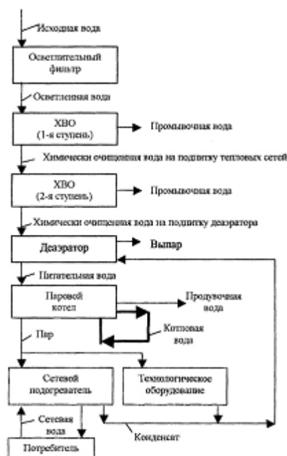
Рис. 2.1. Схема движения воды и пара в теплоэнергетической установке
