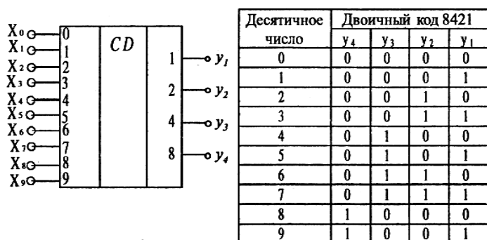
Рис. 1. Схема шифратора и таблица соответствия кода
