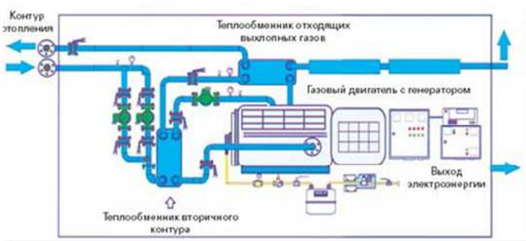
Рис.7. Принципиальная схема газопоршневой когенерационной установки
