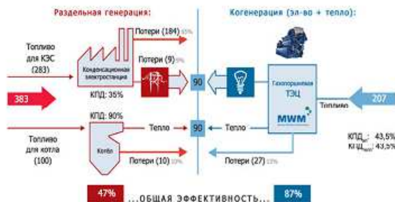
Рис.1. Сравнение энергетических потоков при раздельной и комбинированной выработке энергии (когенерация), (данные приведены в условных единицах топлива).
