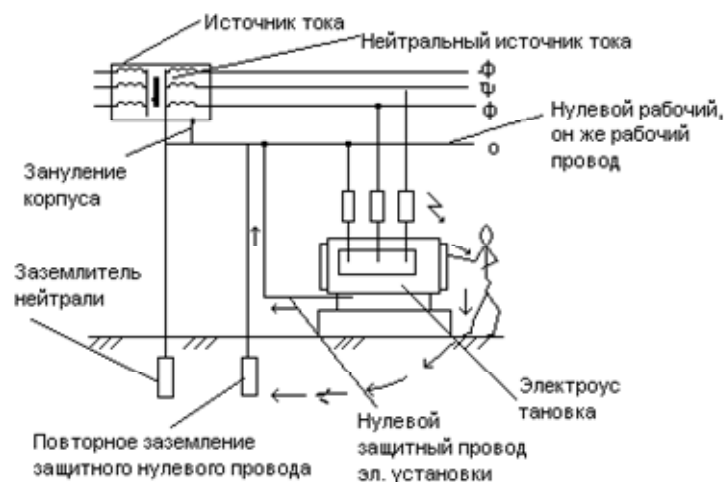
Рис.2 Действие электрического тока при включении в сеть имеющую зануление
