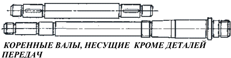
ВАЛЫ ПЕРЕДАЧ, НЕСУЩИЕ ДЕТАЛИ ПЕРЕДАЧ
