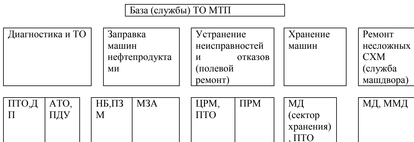
Рисунок 1 - Схема основных служб системы ТО МТП: стационарные средства; передвижные; ПТО – пункт ТО; ДП – диагностический пункт; АТО – агрегат ТО; ПДУ – передвижная диагностическая установка; НБ – нефтебаза; ПЗМ – пост заправки машин;
