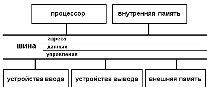
Р и с у н о к 0.1 -- Магистральный (шинный) принцип обмена информацией между модулями
