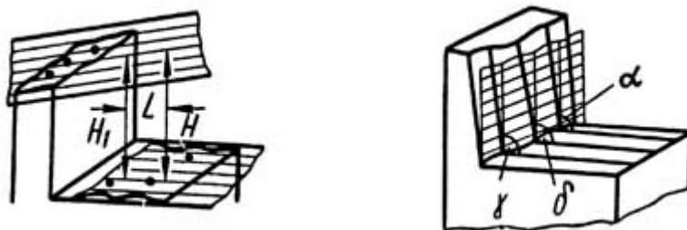
Рис. 1.15 – Нкпараллельность поверхностей и неперпендикулярность
