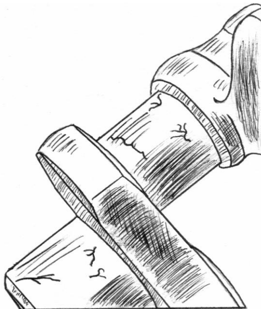
Рисунок 55 – Трещины на шейке коленчатого вала двигателя, выявленные магнитной дефектоскопией.
