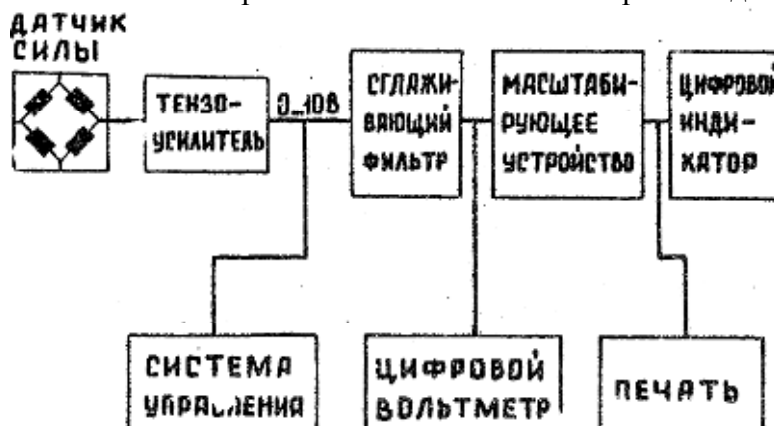
Рис.2.8. Блок - схема системы измерения крутящего момента.
