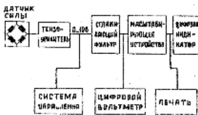
Рис.7.8. Блок - схема системы измерения крутящего момента.
