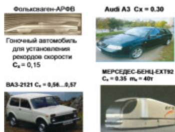
Рис. 3.2 Коэффициент лобового сопротивления некоторых автомобилей
