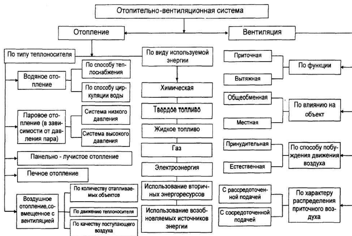
Рис. 1 Классификация отопительно-вентиляционных систем
