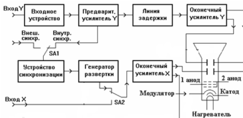
Рис.1 – Структурная схема осциллографа (базовая модель)
