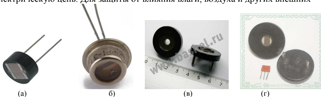
Рис.3 – Фоторезисторы различных типов: а – с рабочей площадкой в виде меандра, б – фоторезистор ФР1-3 (темная прямоугольная полоска - фоточувствительный слой), в – фоторезисторы ФСК-6, г – фоторезисторы ФС-3 .
