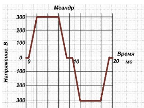
Рис.6 – Форма выходного напряжения автономного инвертора (трапеция)
