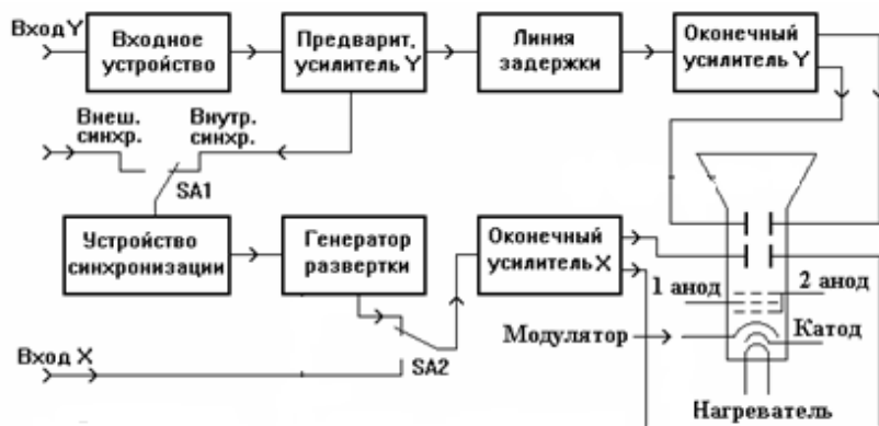
Рис.1 – Структурная схема осциллографа (базовая модель)
