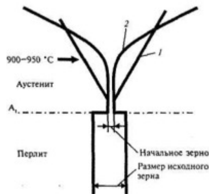
Рис.3. Схема роста зерна различных видов стали: 1 – наследственно крупнозернистой; 2 – наследственно мелкозернистой
