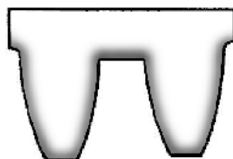
Рис. 4 Макроструктура науглероженого зубчатого колеса
