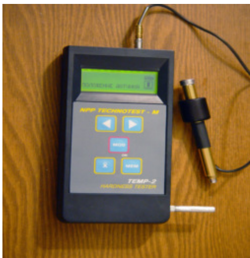
Рис. 6. Твердомер ТЭМП-2 и измерение твердости прибором
