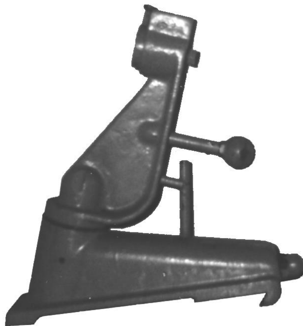
Рисунок 6 – Правильный прибор для радиусной правки круга.
