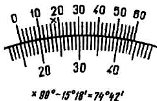
Рис. 7.5. Комбинации измерительных звеньев и чтение размеров при измерении внутренних углов от 90 до 40°
