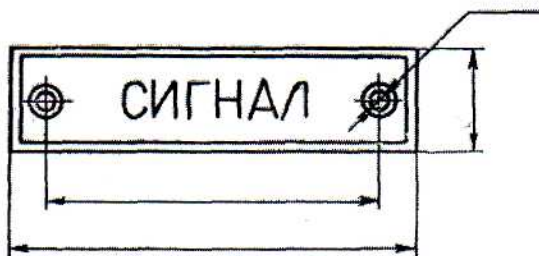
Рис.6. Простановка размеров для нанесения надписи на изделия
