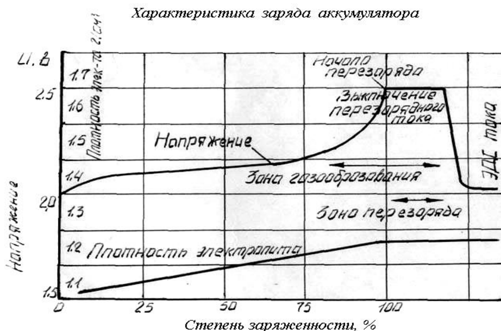
Рисунок 2 – Зависимость напряжения одного элемента батареи и плотность электролита от степени заряженности в процессе зарядки
