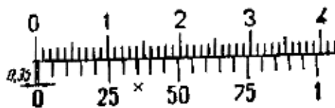
Рис. 3. Пример отсчета штангенциркулем ШЦ-2
