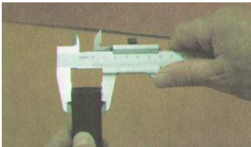
Рис. П2. Измерение наружного размера
