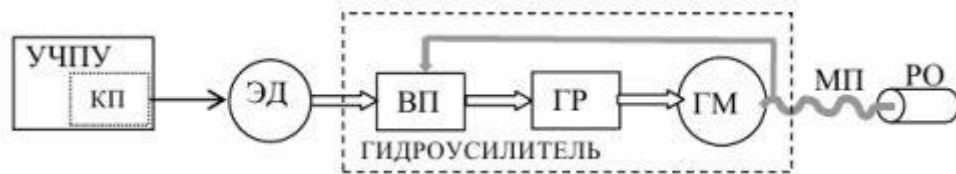
Рис. 5. Функциональная схема электрогидропривода
