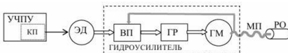
Рис. 5. Функциональная схема электрогидропривода
