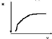
Рис.1.9. Зависимость эффективности N от линейной скорости потока подвижной фазы
