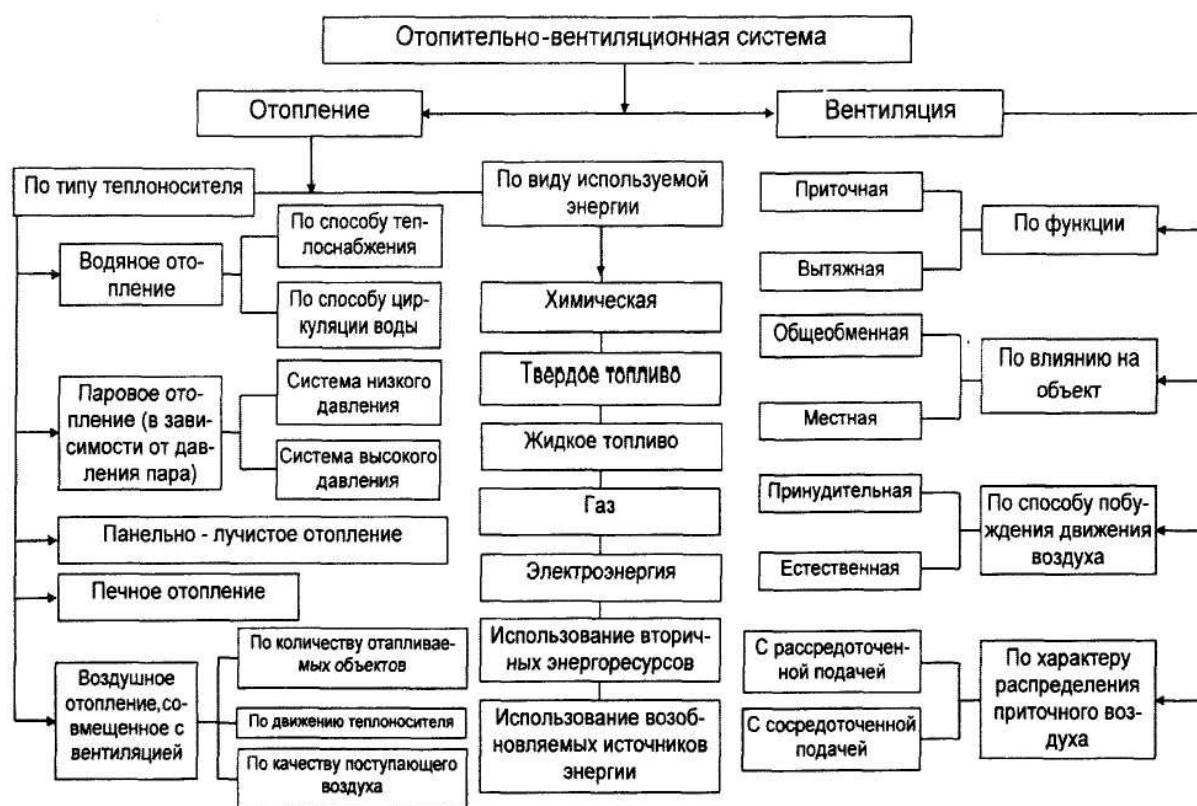
Рис. 1 Классификация отопительно-вентиляционных систем
