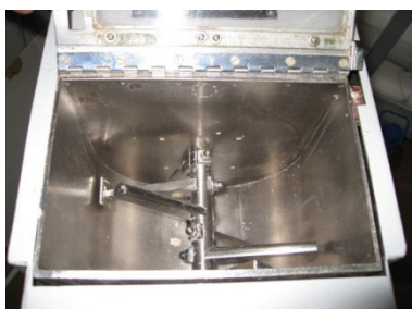
Рис.59 Лабораторный макаронный пресс АМЛ-1: а) внешний вид; б) однокамерная месильная емкость
