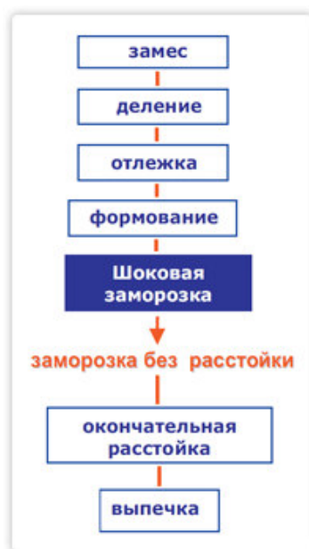
Рис.1 - Технология изготовления замороженных тестовых полуфабрикатов, требующих окончательной расстойки
