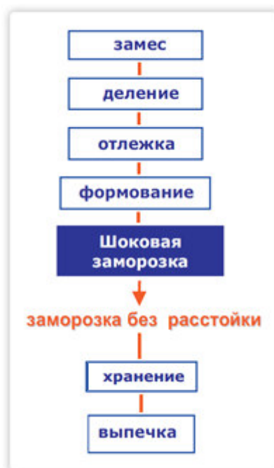
Рис.5 Технология изготовления замороженных полуфабрикатов без расстойки, готовых к выпечке «РАФ»
