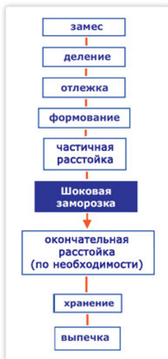
Рис.6 Технология изготовления частично расстойных замороженных полуфабрикатов
