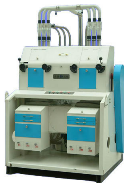
Рисунок 13.1 – Лабораторная мельничная установка МЛУ-202
