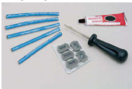
Вариант возимой "аптечки" для бескамерных шин.
