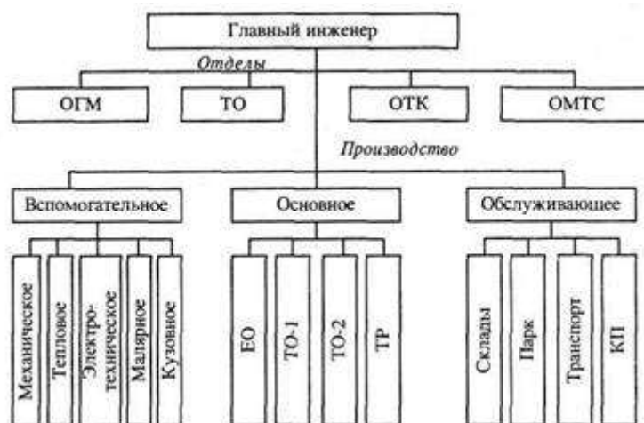
Рис. 1. Организационная структура системы обслуживания и ремонта подвижного состава АТП
