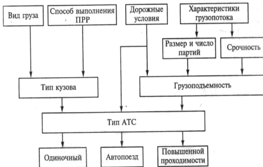
Рисунок 1 – Схема выбора типа подвижного состава для перевозки грузов
