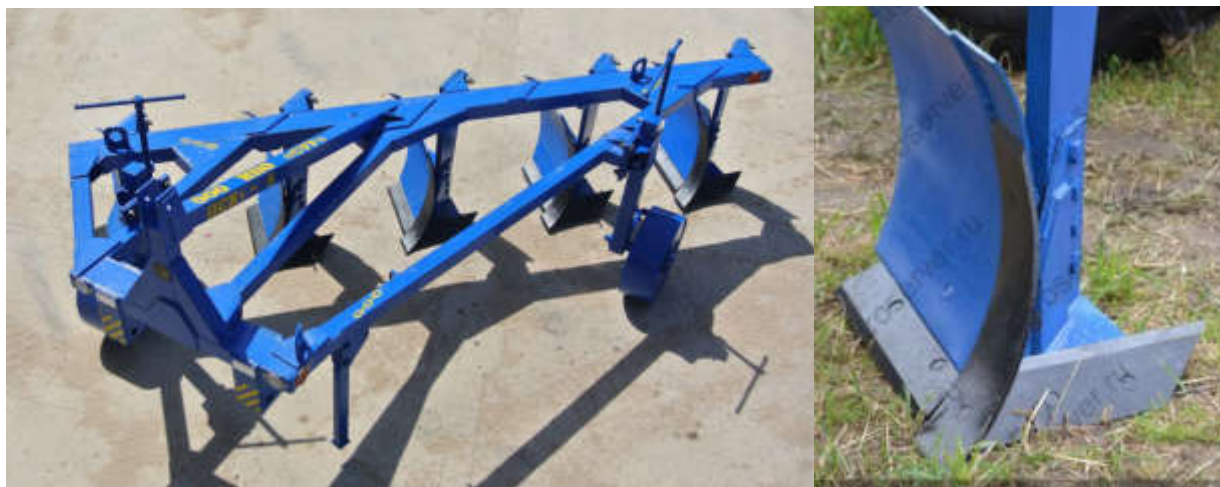
Рис. 2 – Энергосберегающий плуг навесной пятикорпусной серии ПСК-5
