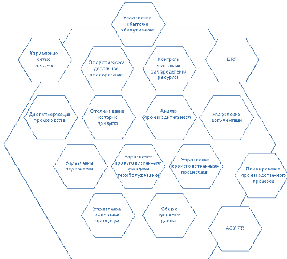
Рис.1 Функциональная модель MES
