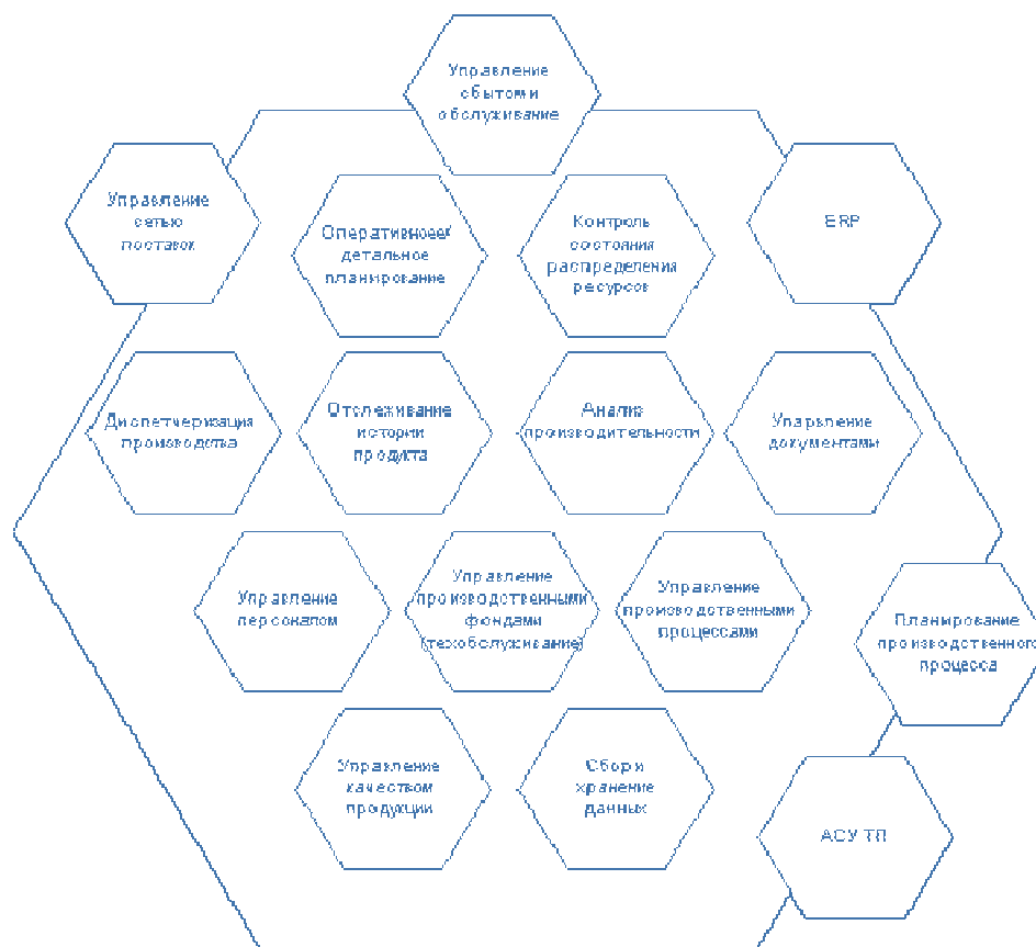
Рис.1 Функциональная модель MES
