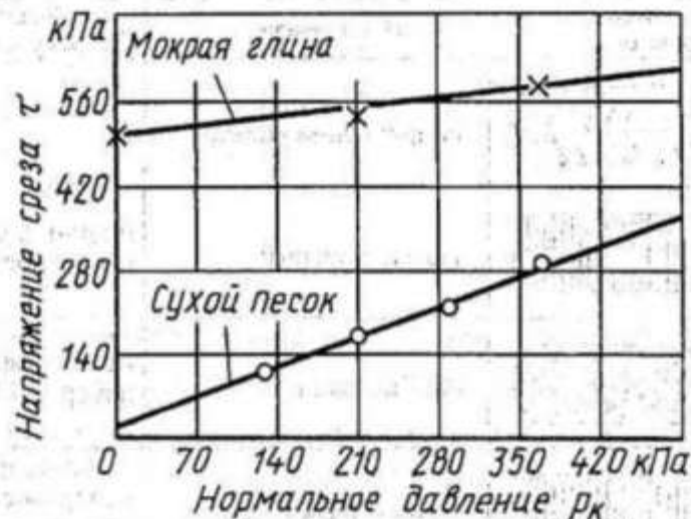
Рис. 14.7. Зависимость сопротивления грунтов касательным сдвигом от нормального давления на грунт.
