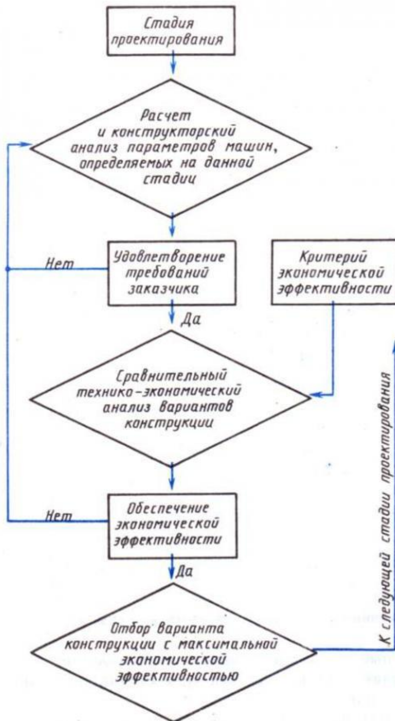
Рис. 4.2. Укрупненная схема проведения ТЭА машины на стадиях проектирования.
